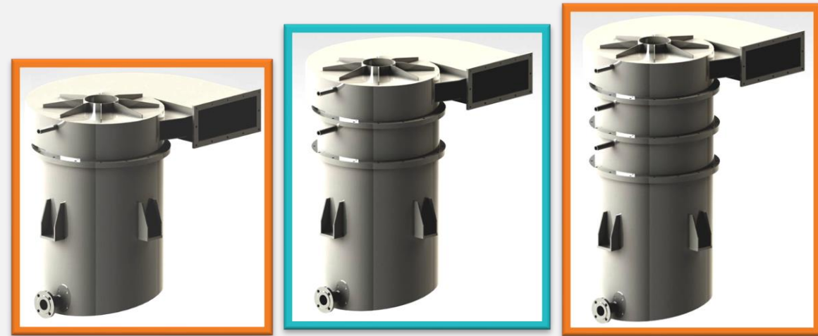
图.3:单、二、三级的离心式鼓风机, 采用蜗形旋转器 (切线的进气室), 变形-1.
