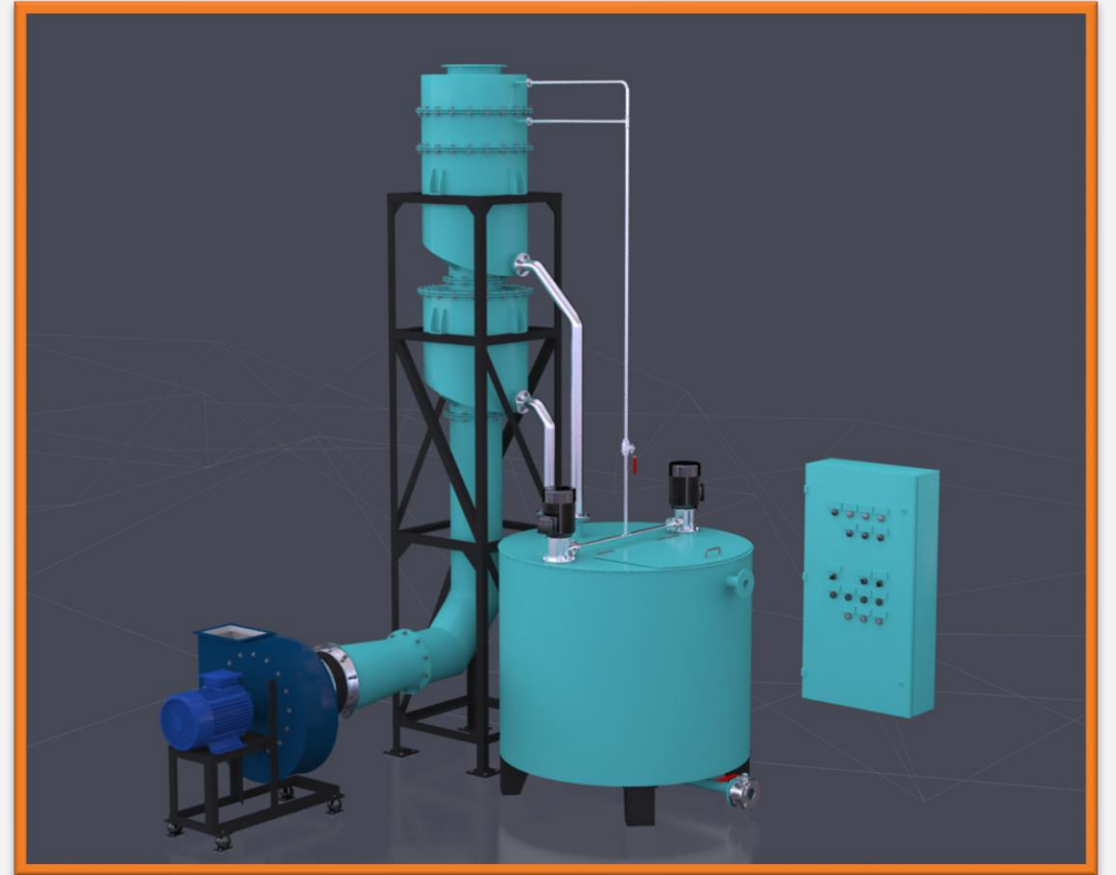
图 7:有捕滴器的离心式鼓风装置
